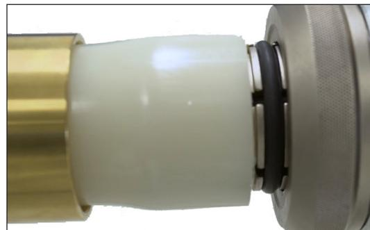
Unmittelbar danach, die Stützbuchse in das Rohrende schieben.
